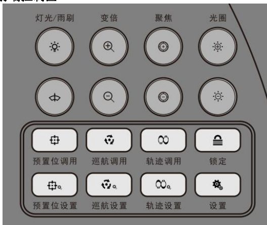
【图 2-4】 PTZ 及前端设备操作区
